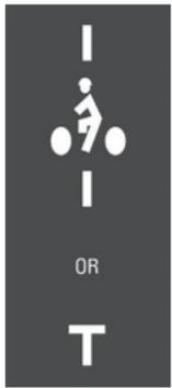
Los detectores de bicicletas informan al semáforo cuando un ciclista está esperando la luz verde. Las marcas indican dónde colocar las ruedas en el pavimento para hacer que la señal cambie. Coloque su bicicleta en el símbolo del detector de bicicletas para activar la luz verde.
